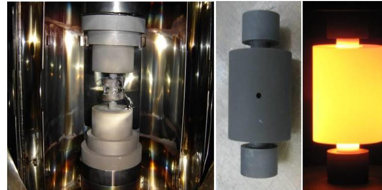
$T = 1100^\circ\text{C}$ ;  $t = 3'$ ;  $\text{Atm.: Vacuum}$ ;  $P = 50 \text{ MPa}$
